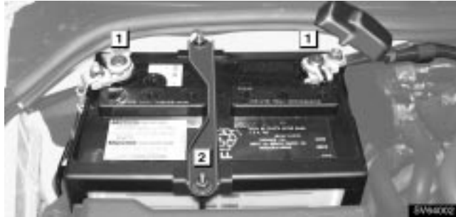
► 1 Terminals 2 Hold-down clamp
